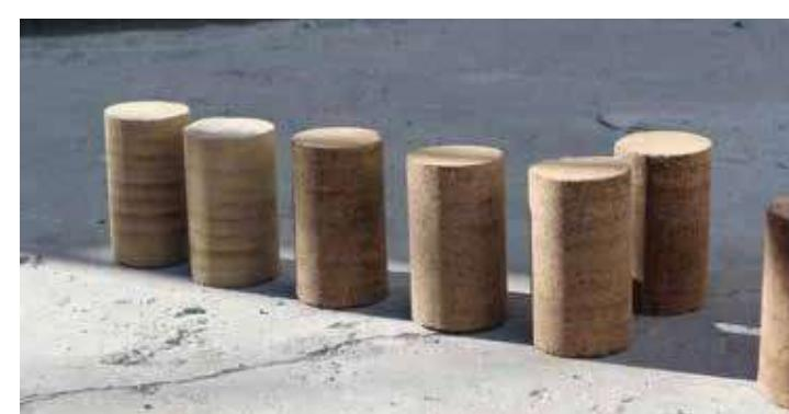
セラミック（瓦）の粉碎物と粘土を配合した非焼成ブロックの供試体。
