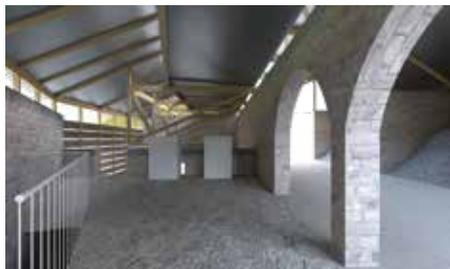
初期工場は、外部からの廃棄セラミックの搬入と、採土場からの土の搬入動線からその位置を決定した。労働者の動線と車両動線が交わらないようなプランニング。地形の高低差を生かし、原料である土やセラミックを1Fで粉碎、ふるいにかけて、材料化した素材を位置エネルギーを用いてB1におろす。おろした材料で非焼成ブロックの圧縮機械により、成形を行う。
