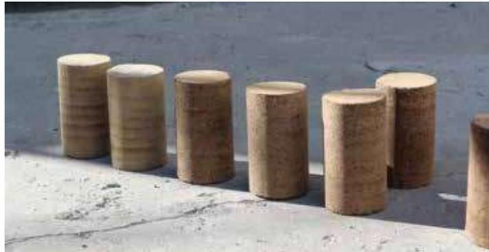
セラミック(瓦)の粉砕物と粘土を配合した非焼成ブロックの供試体。
