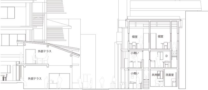
駐車場付き木造3階建住宅 C-C 断面図 0 1 3 5m
