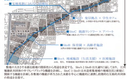
路地の大きさと水路を距離の関係性から用途を決定する。SiteAとSiteBは大幅に面しており、江川堀線状共同体の中でもバリエーション機能を生かす。SiteCとSiteDは木造密集地域の地域住民と密接に関係する機能を計画し各敷地の機能が再生された水路を中心に機能的に連携し互助的共同体の形成を目指す。
