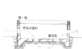
建築基礎部分をコンクリートで埋めるという解答ではなく、通気口を設ける。建築を支えるという性能を担保しながら、地中に水と空気の通り道を作ることによって地中にとって良好な環境を築く。
