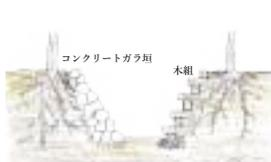
コンクリートガラや木材を組み、表面を形成する。植物の根が絡むことで強度が増し、造作と自然とが一体となり、時の流れと共にまちの風景を作り出す。表面に現れる隙間が、小さな生物たちの住処となる。
