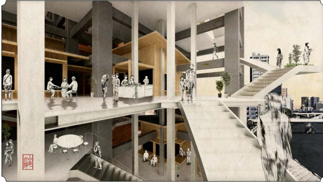
川床が階段でつながる。客室に加えてシェアキッチンやオフィスも混在しているため、地域に開かれた川床はホテルのオフシーズンでも賑わっている。様々な向き・形状の階段は隅田川への多様な視点場になる。客室と舟の壁には扉戸があり、開閉が可能になっている。これは、江戸時代の水際の料亭のように、水辺の涼しい風を室内に取り込み、自然喚起を行うためである。また、室内外の交流を生む装置でもある。
