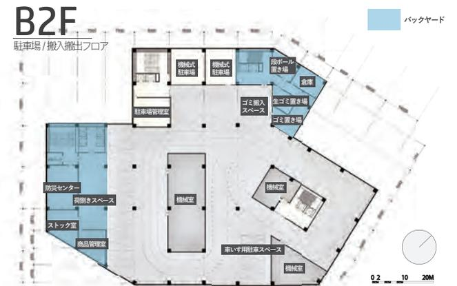
施設のバックヤードは、敷地において既存の周辺建物が隣接し、視覚的な効果が発生しない北西面に設け、地下駐車場の西面には荷捌きスペース、北面にはごみ搬出スペースを設けた。これら二つのコアで垂直に施設全体を結ぶことで効率的な搬入搬出が行えるような計画としている。来客層用の駐車スペースは機械式のものを採用し、現在進行している計画に沿って160台の駐車スペースを確保している。またB2階の東面には車いす用の駐車スペースを配置して、身障者の利用も考慮した計画としている。
