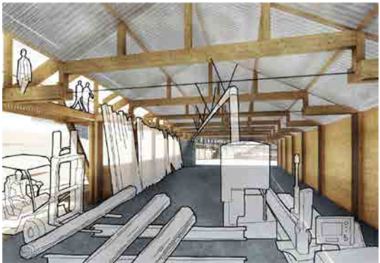
大径木の製材設備と不材アップラーを設けることで、大径材を利用する地盤を整え、利用価値の低い材まで利用する。屋根の間の空間は来訪者のための観賞空間となり、壁に立てかけられた木の木口を見ながら品定めできる。
