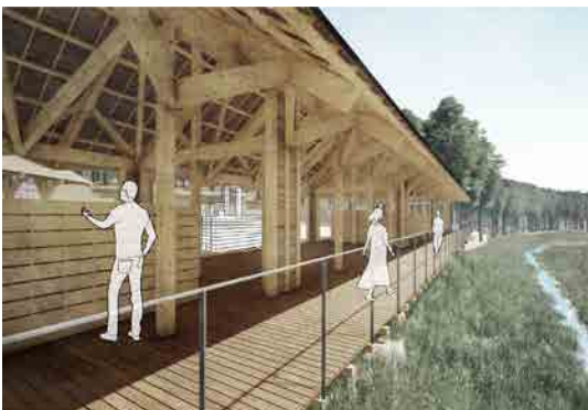
天然乾燥機は敷地の南西から吹く風を取り込み、風通し南西から吹く風が建物吹き抜けるように川に張り出して配置し、川側に観覧客のための通路を設けることで眺望を得ながら、売場状況でストックされ
