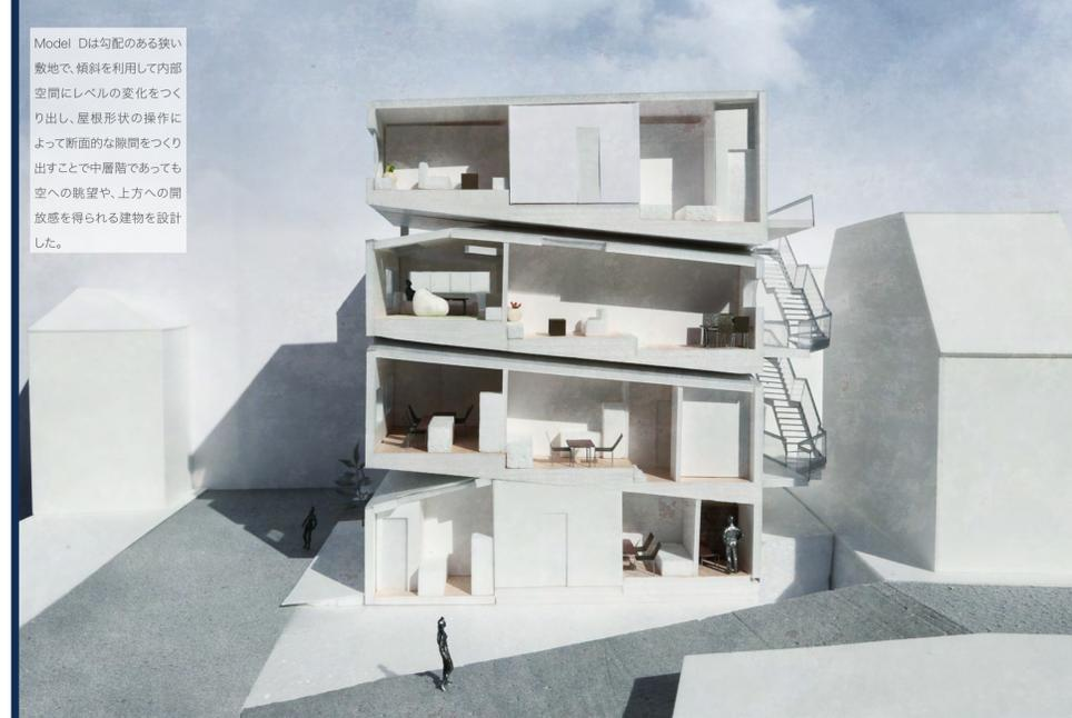
Model Dは勾配のある狭い敷地で、傾斜を利用して内部空間にレベルの変化をつくり出し、屋根形状の操作によって断面的な隙間をつくり出すことで中層階であっても空への眺望や、上方への開放感を得られる建物を設計した。
