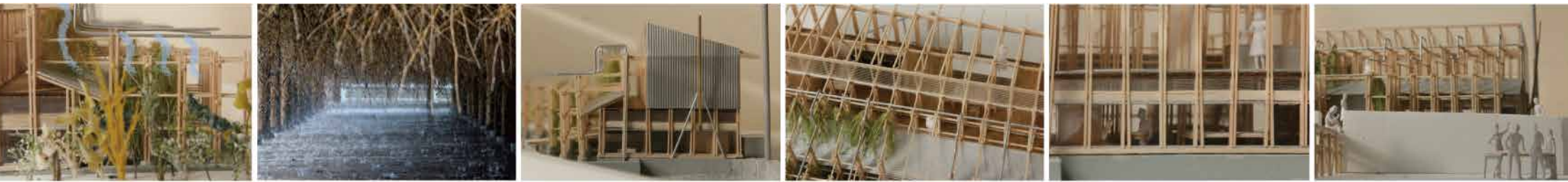
ハサミ柱をきっかけに竹の枝がかけられている。その上から設備を通して海水が噴射される。
