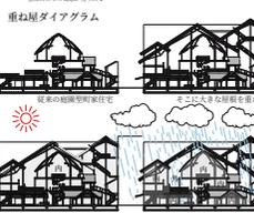
目がくらむような熱射を避けるために二重に家根を架け、断熱層でもあり通風もできるようなになっている。私はこの考えと重ね合わせの空間を同時に達成する“重ね屋”という様式を導き出した。
