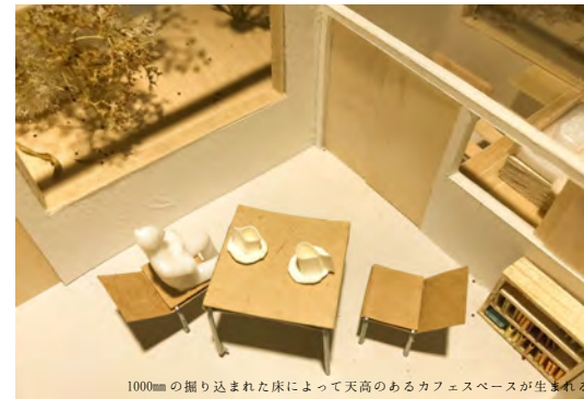
1000mmの掘り込まれた床によって天高のあるカフェスペースが生まれる
