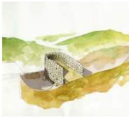
風に耐える石積みも、風を受け流すための水平面とする。
