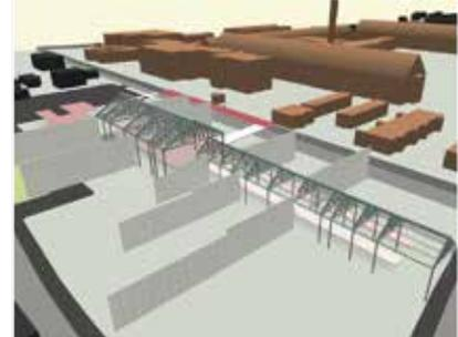
耐火被覆板を施した鉄骨のキングポストトラスにSRC造の耐力壁を付加する。
