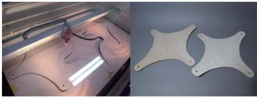
上下の部材は全く同じ寸法である。3Dで設計し、幾何学的に解くことで、曲げることによって上下の部材が完全に合わるようになっている。また、部材の切り出しはレーザーカッターで行った。
