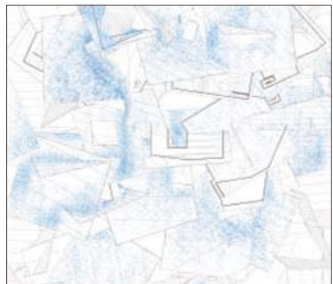
屋根面を流れる雨の方向を示している。雨の貯まる部分には貯水槽を設け、雨水利用を行う。
