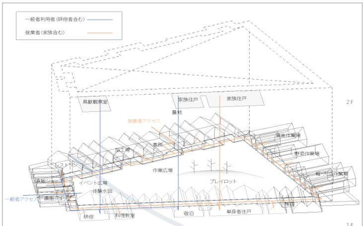
図5 機能構成及び動線計画図
