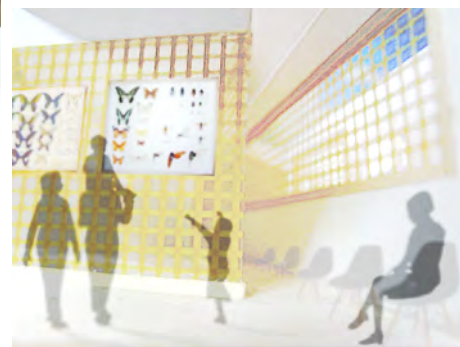
木質面格子は構造を負担する他、インテリアとしても利用する。
