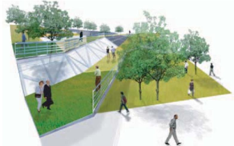
地下商店街エリアの外観パース：ガラスやソーラーパネルなどの材料によって構成されているため、歩きながら内部が見えたり、地下部分に光が差し込むようになっている。
