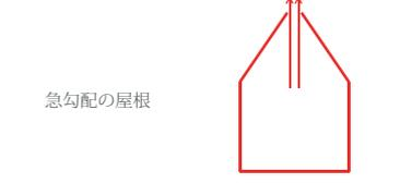
雨仕舞上げはもちろんのこと、屋根裏の気積が大なので断熱性にすぐれ、また煙突効果による換気も期待できる利点がある。
