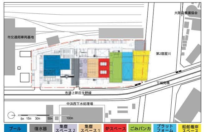
図-12 配置図と主設備の関係
