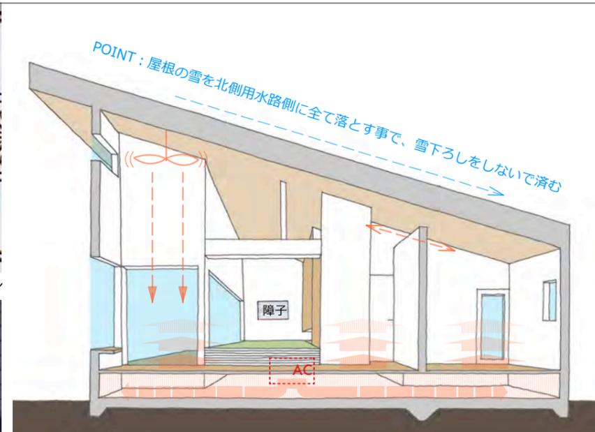
平屋の特性でもある、全ての部屋の下にある基礎を生かし、床下で空調をする事により、建物全体を20℃前後の温度で一定にする。このケースでは、温水ファンヒーターを用いて、ガス熱源とし、通常エアコンよりもパワーのある機械を設置している。建物全体は高气密としている。玄関などのポイントで少し孔を空ける事により、通常玄関からの寒い空気がくるペリメーターゾーンが寒くなるのをコントロールする。通常温水床暖房に比べ、床の温度は高くないが、空調機のエリアも限定しない、高齢者配慮の全館空調的な考え方の空調システムとしている。
