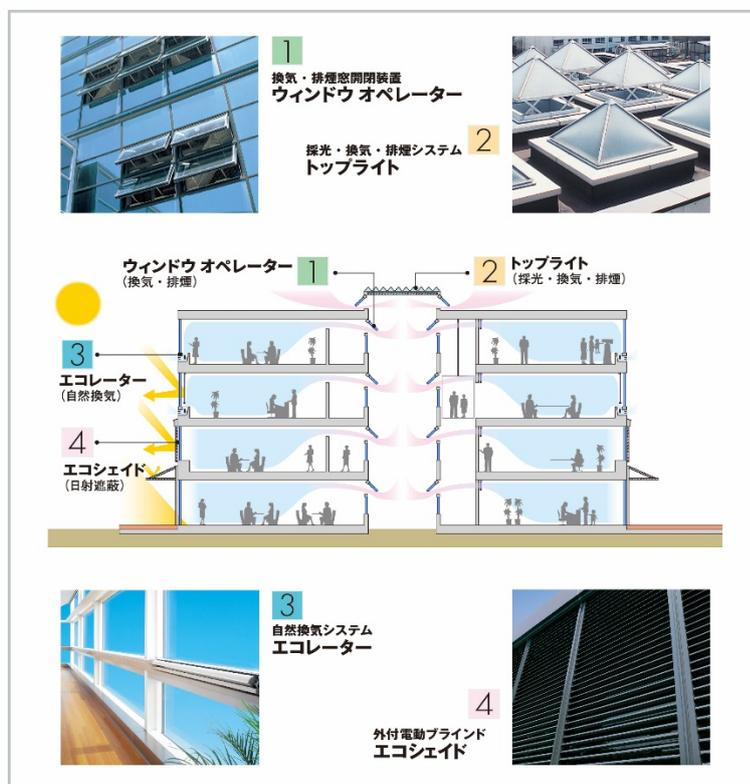
■コメント：「オペレーターって、操作する人？」などと誤解されることもある排煙窓オペレーターですが、自然換気を自動で行うためにお使いいただくことも可能です。コロナ禍以降「換気で使用したい」というお問い合わせが増えております。換気に適したオペレーター製品や、自然換気装置のラインナップもございますので、ご相談ください。
