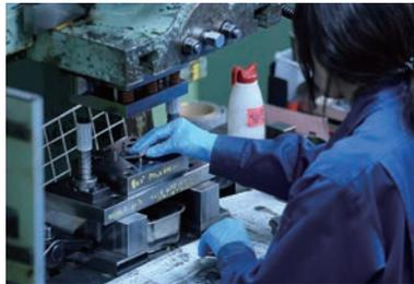
材料を金型にセットしプレス加工
