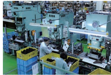
プレス加工の作業風景。工場には数千の金型が保管されている
