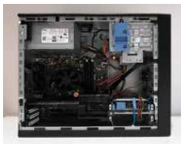
PCではCPU・ハードディスクドライブ・電源ユニット等の各部品は自己完結型の機能を持ち、他社製品との入れ替え可能
