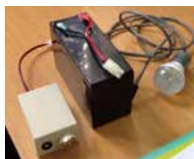
再生バッテリーによる照明ユニット
