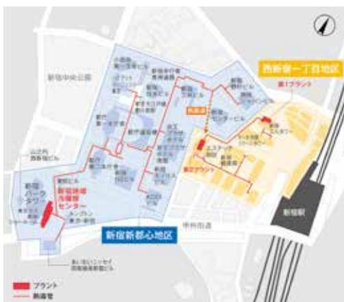
新宿 DHC 供給範囲と導管布設状況(新宿地域冷暖房センターパンフレットより)
