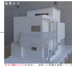
住宅 n-3 20 わき腰に入り口を採用し、道路との距離を調整している。
