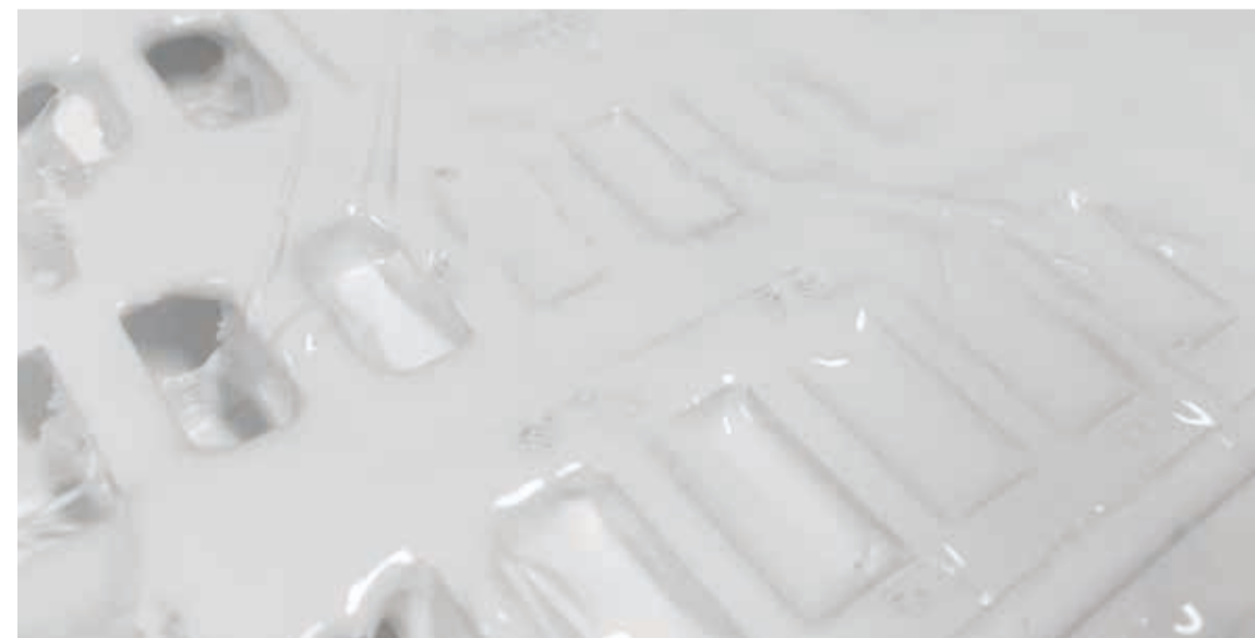
シリコンを射出体内側に流し込むために 天井面と底面に四角い開口を開けている
