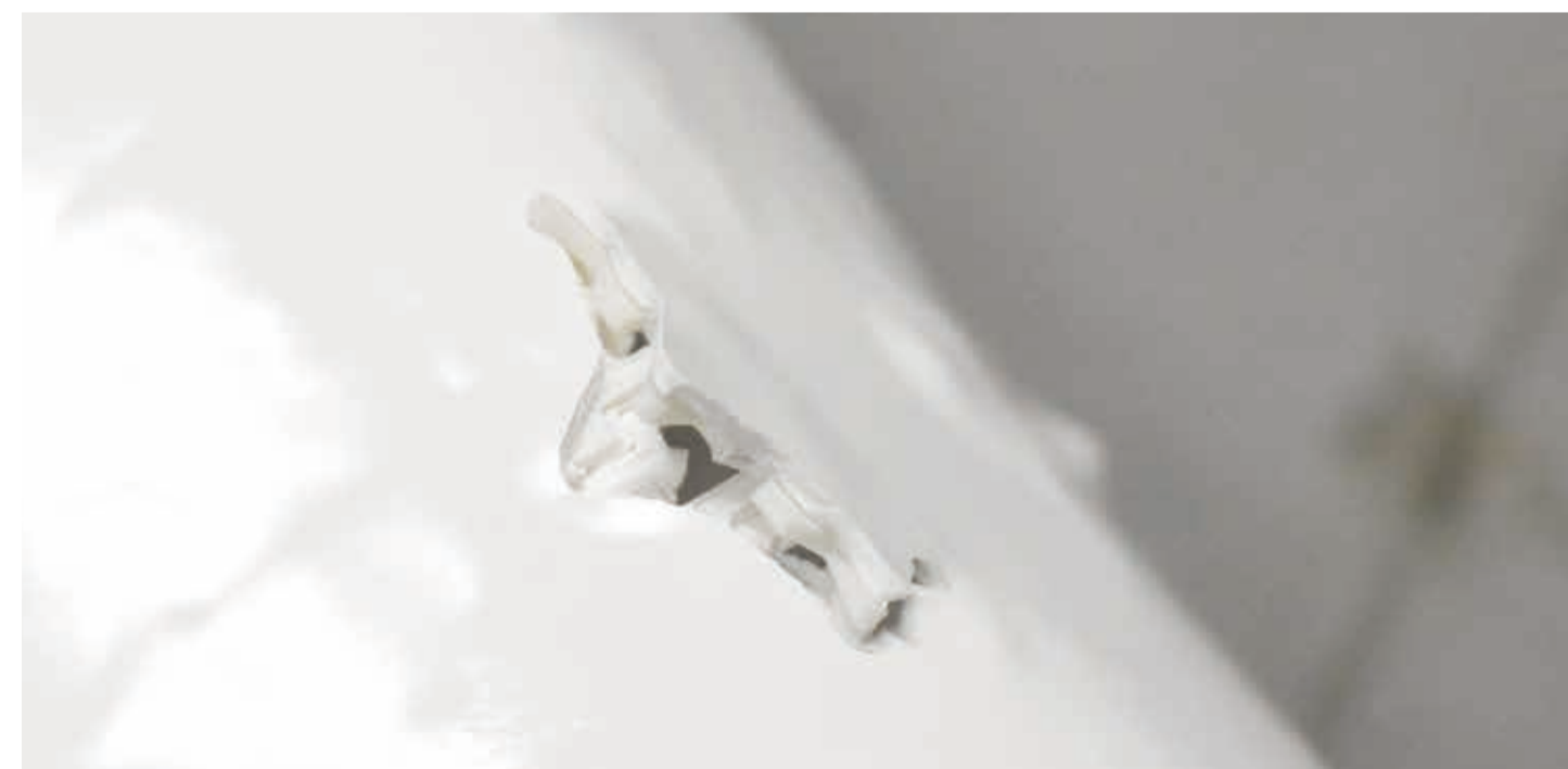
このパーツをつけないと荷重をかけた際に射出バーがシリコンを突き破ってしまう
