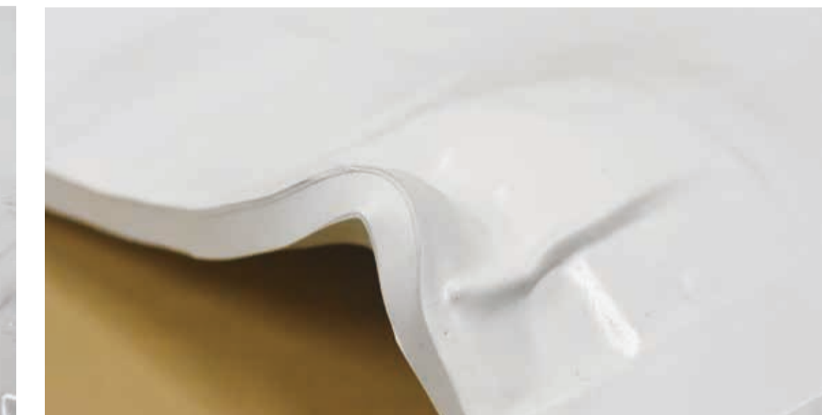
穴をあけないとシリコンに中空部分ができ、 荷重をかけた際に内側に座屈してしまう
