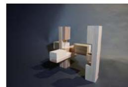
D材の狭い切り欠きでC材が挟まるよう、D材を立てる。
