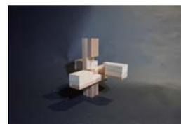
C材をB材にはめ込み、A材の下へ合わせる。
