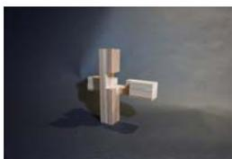
B材の切り欠き部分にA材をはめ込む。
