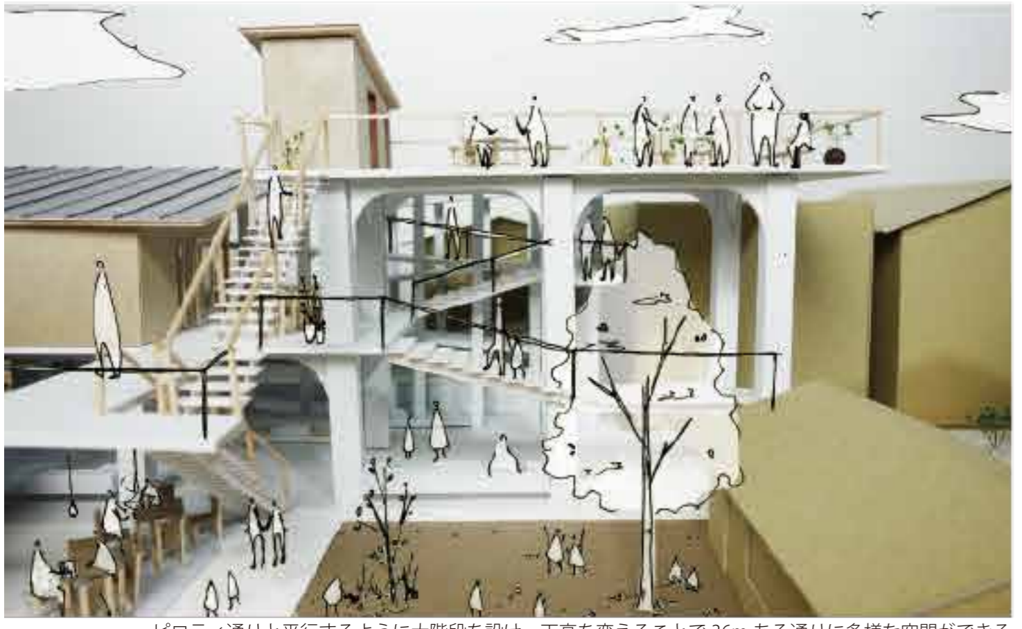
ピロティ通りと平行するように大階段を設け、天高を変えることで36mある通りに多様な空間ができる
